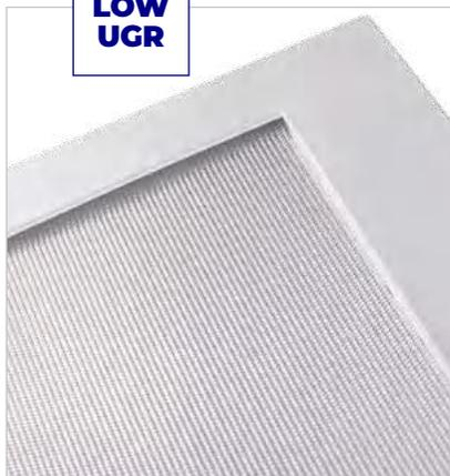
W panelach Kanlux BLINGO moduły LED usytuowane są na tylnej ścianie panela i świecą kierunkowo w dół. To panele typu backlite wyposażone w soczewki poszerzające kąt emisji światła, które gwarantują równomierność podświetlenia. Wyeliminowanie płyty światłoprzewodzącej minimalizuje możliwość żółknięcia oprawy i pozwala uzyskać lepsze parametry świetlne. W Kanlux znajdziesz również całą gamę akcesoriów do paneli Kanlux BLINGO.
